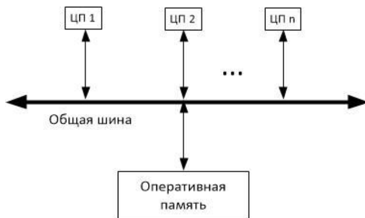
Рисунок 1. Структура СМРС с однородным доступом к памяти
