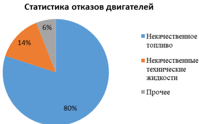
Рисунок 1. Диаграмма причин отказов двигателей
