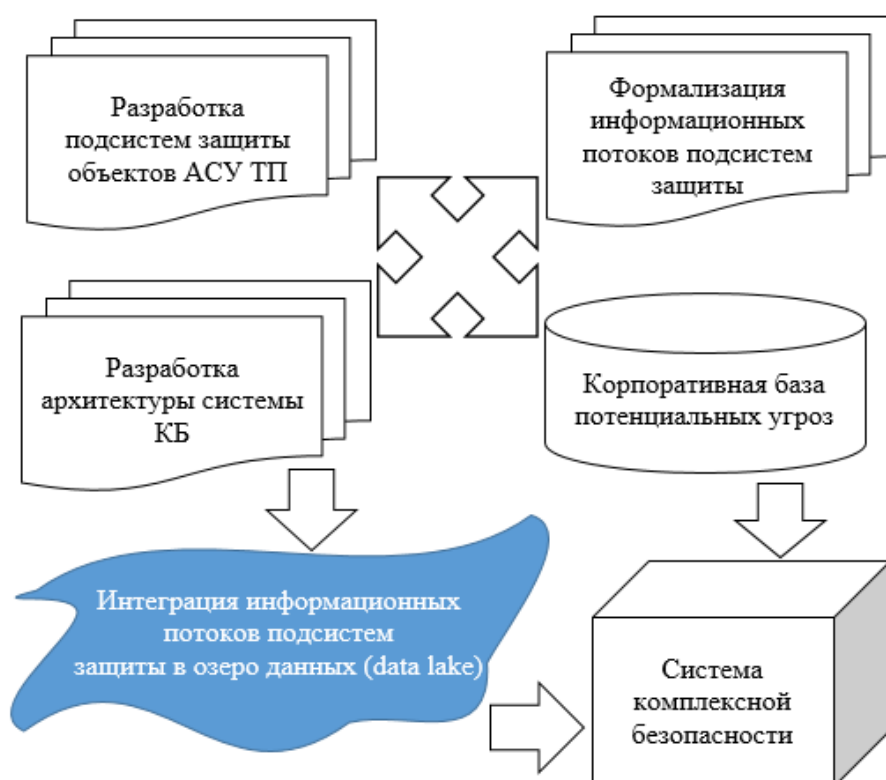
Рисунок 3. Модель интеграции подсистем безопасности АСУ ТП в единую систему комплексной безопасности
