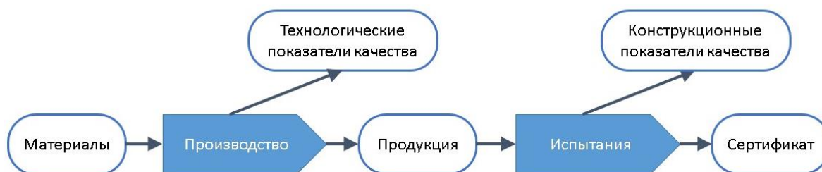
Рисунок 3. Обобщенная функциональная модель технологического процесса со сквозным контролем качества
