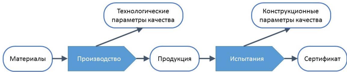
Рисунок 4. Последовательность контроля параметров, определяющих технологическое и конструктивное качество изделий машиностроения
