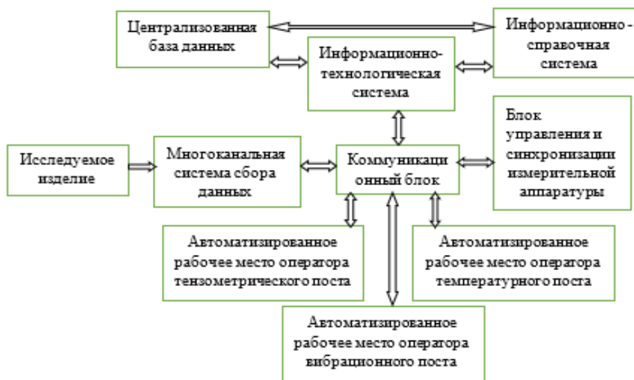
Рисунок 1. Структура автоматизированной информационно-измерительной системы прочностных испытаний изделий спецхимии
