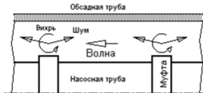
Рисунок 7. Образование шумов от муфт НКТ при прохождении звуковой волны
