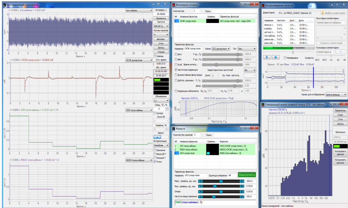
Рисунок 3. Обработка показаний датчика ускорений пола кабины в программе ZETLAB ANALIZ (время интегрирования 5 с)
