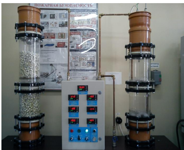
Рис. 1. Внешний вид установки по изучению массообменных процессов
