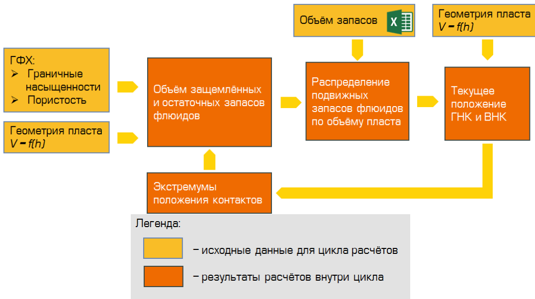
Рисунок 3. Схема работы алгоритма расчёта положения контактов.
