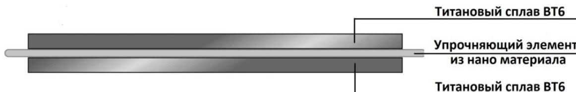
Рисунок 1. Схема получения слоистого композитного материала с различными структурами с применением упрочняющего элемента с НК структурой
