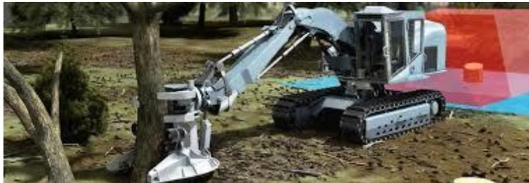
Рисунок 1. Определение препятствия в «слепой зоне» машины [1]
