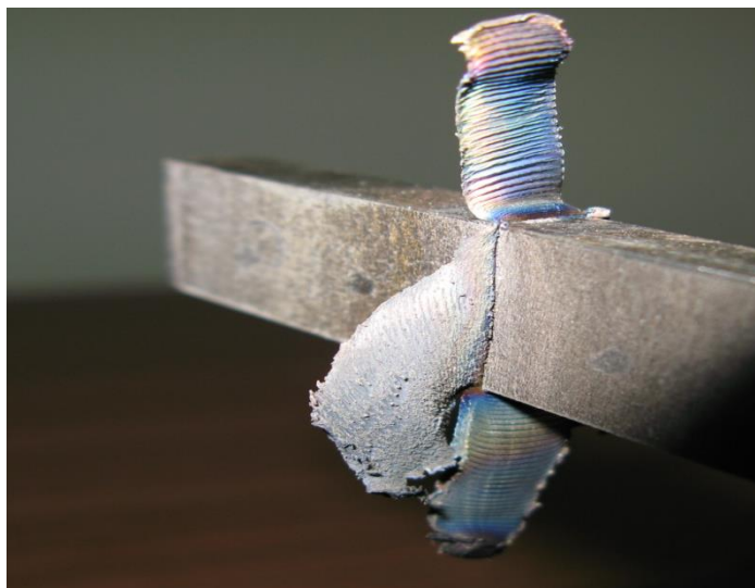
Рисунок 3. Образец из сплава ВТ9, полученный линейной сваркой трением
