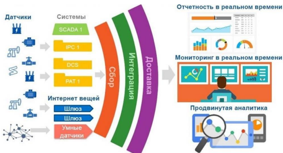
Рисунок 2. Структура MES-системы PISystem
