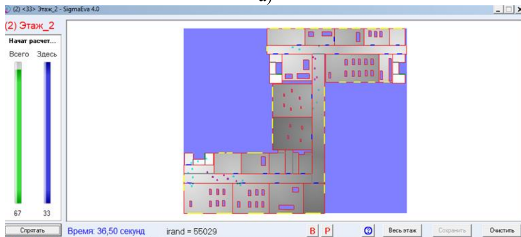
Рисунок 6. Окно динамики процесса эвакуации: а) на первом этаже здания; б) на втором этаже здания
